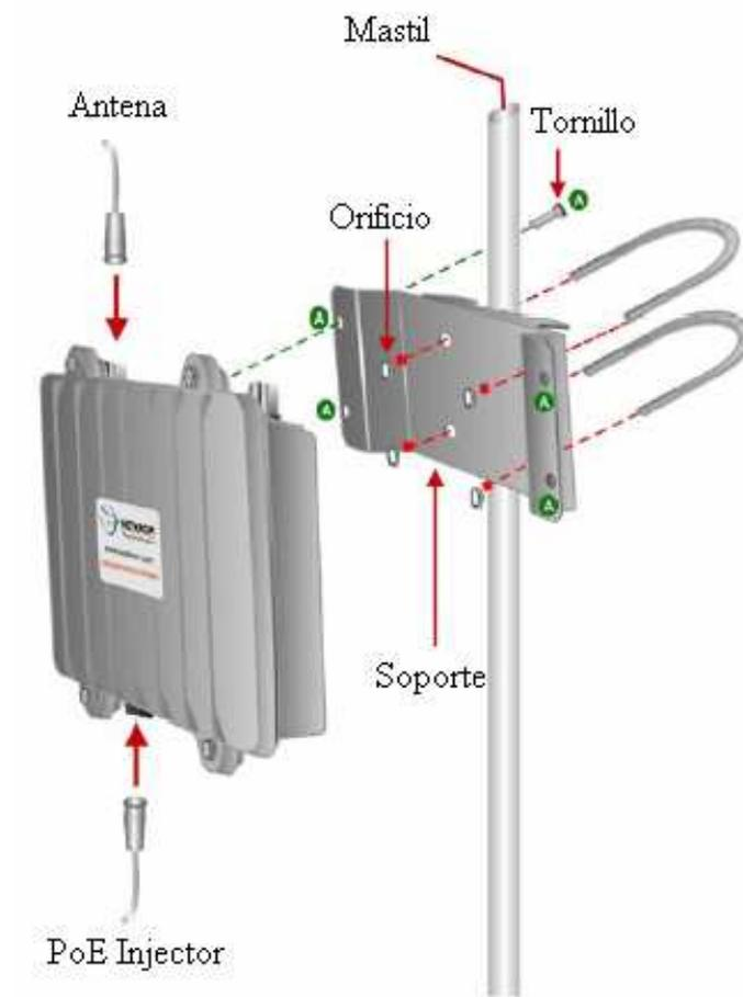
Fig. 4.26 - Router Netkrom incluido en soporte
