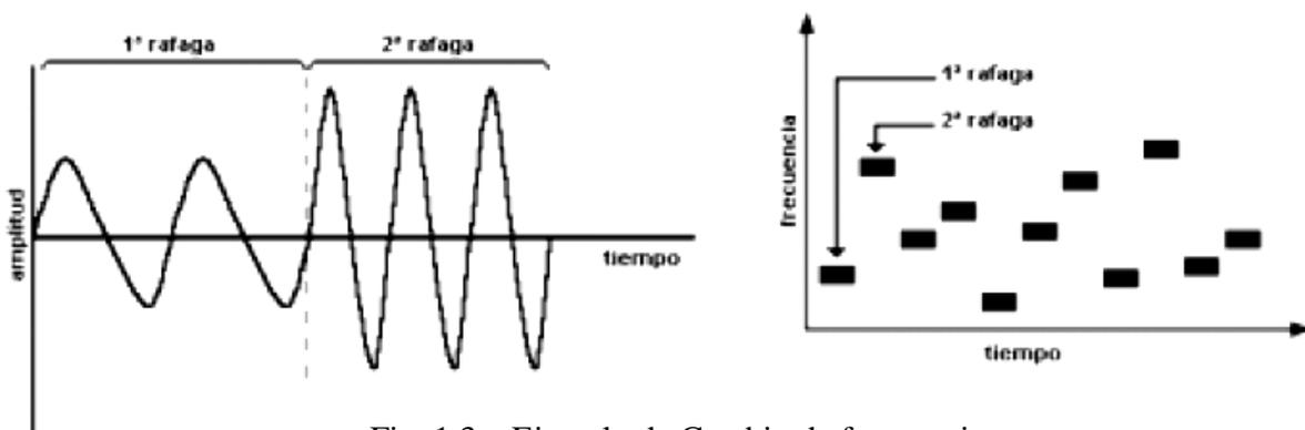
Fig. 1.3 – Ejemplo de Cambio de frecuencias
