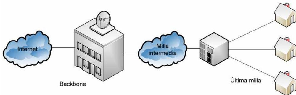
Fig. 1.10 Funcionamiento general de diseño de red
