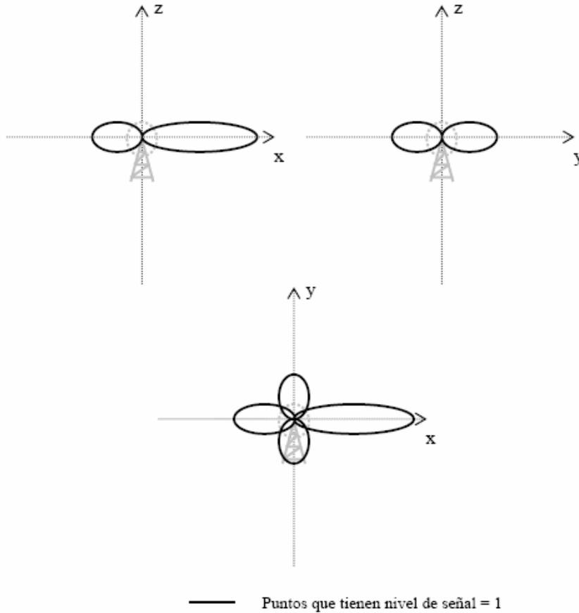
Fig. 2.5 – Gráfico de propagación direccional en función de los ejes x, y, z
