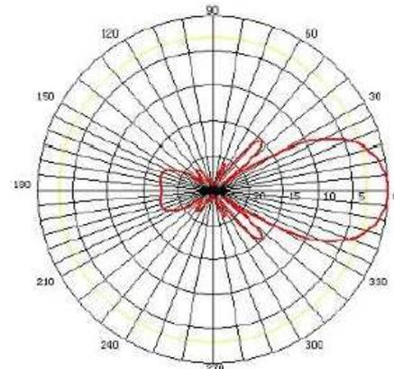
Propagación antena de 13 dBi
