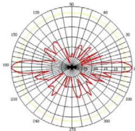
Propagación de antena en los 900 Mhz
