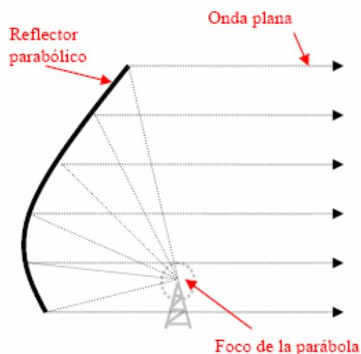
Fig. 2.6 - Transmisión de onda plana en antena parabólica
