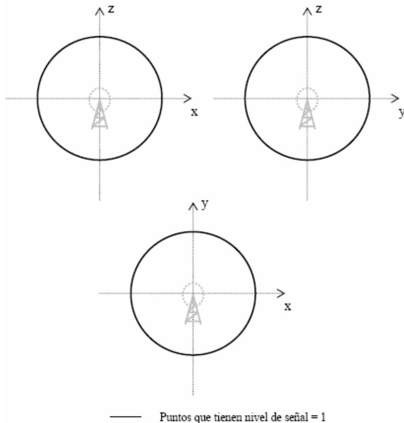
Fig. 2.1 - Gráfico de propagación isotropico en función de los ejes x, y, z
