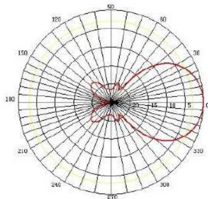
Propagación antena de 11 dBi
