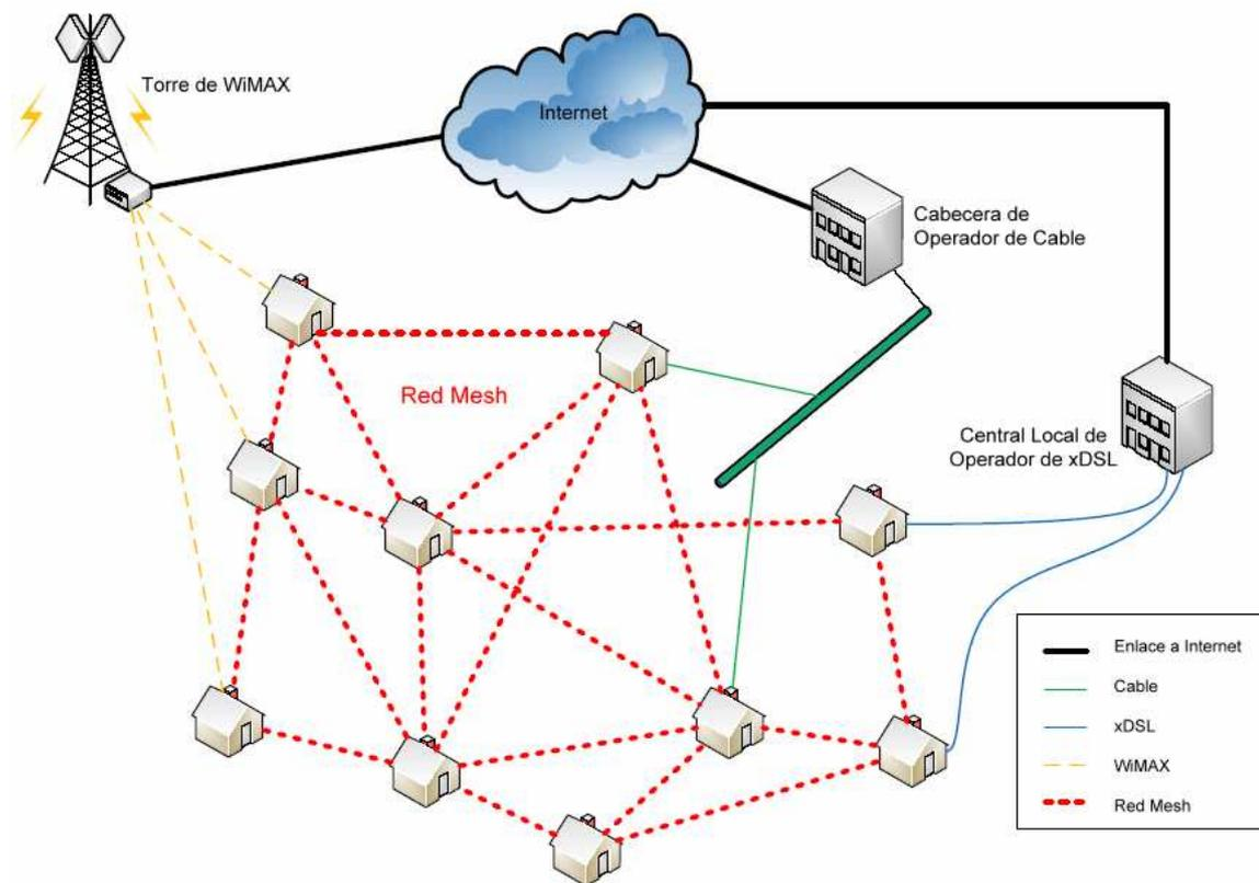
Fig. 1.11 Red Híbrida Mesh con aplicación cableada
