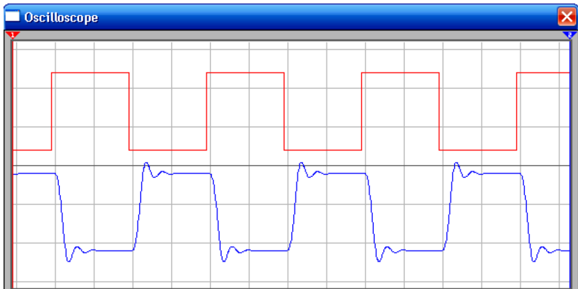
Figura 3.8. Con 100 Hz se ve la fundamental, la tercera, quinta, séptima y novena armónica de la señal cuadrada.
